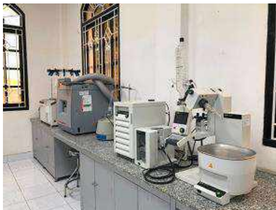
Hình 5: Hệ thống cô quay chân không
